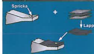
Reparation av spricka med hjälp av kompositmateriel
